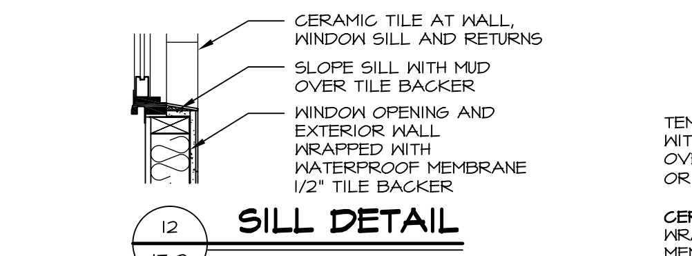
12 SILL DETAIL SCALE: 1" = 1'-0"
