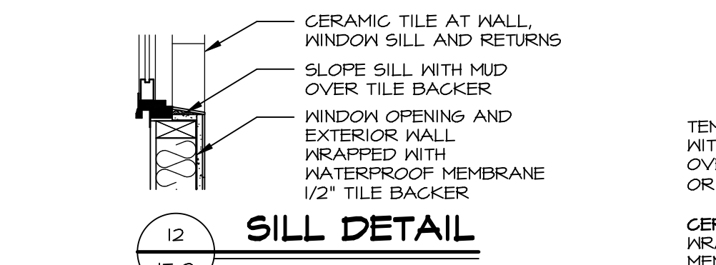
13 SILL DETAIL SCALE: 1" = 1'-0"
