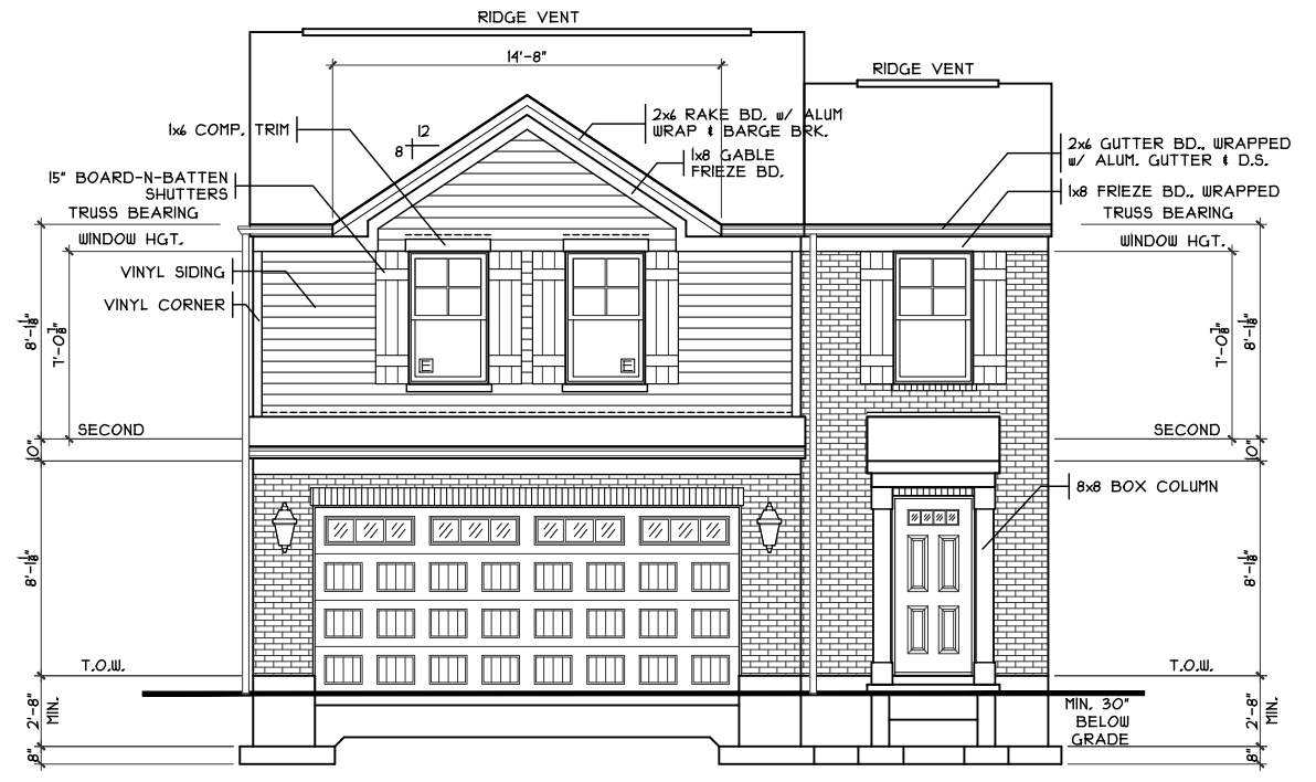
FRONT ELEVATION SCALE: 1/8" = 1'-0"
