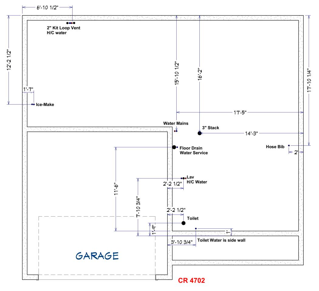
**3" SEWERS 4X2 REDUCER FOR FLOOR DRAIN**
