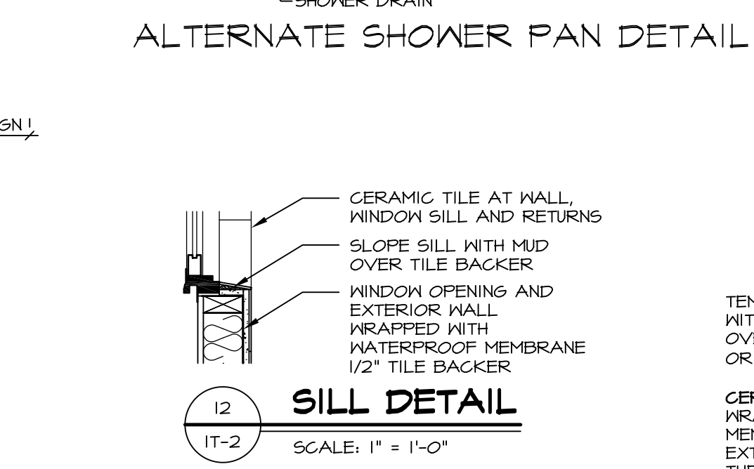
13 SILL DETAIL SCALE: 1" = 1'-0"
