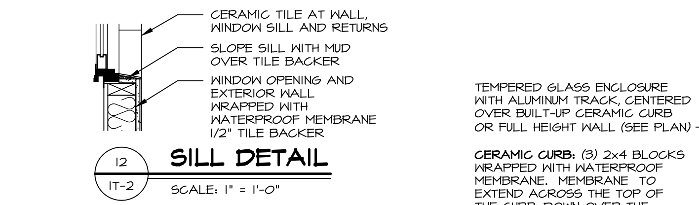
13 SILL DETAIL IT-2 SCALE: 1" = 1'-0"
